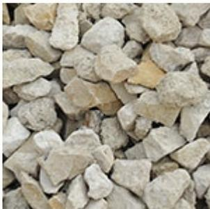
Производимый щебень различных фракций 10-20, 20-40, 40-70 служит прекрасным инертным заполнителем как при осуществлении строительных работ гражданского характера, так и в процессе строительства автодорог. Щебень, марки 500 и выше отвечает самым высоким требованиям по качеству предъявляемым к строительным материалам, а так же экологической безопасностью как используемого исходного сырья, так и всего производственного процесса в целом.
